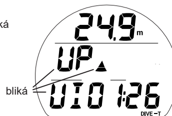
ALARM PORUŠENÍ (VIO) (po zvukovém alarmu)
